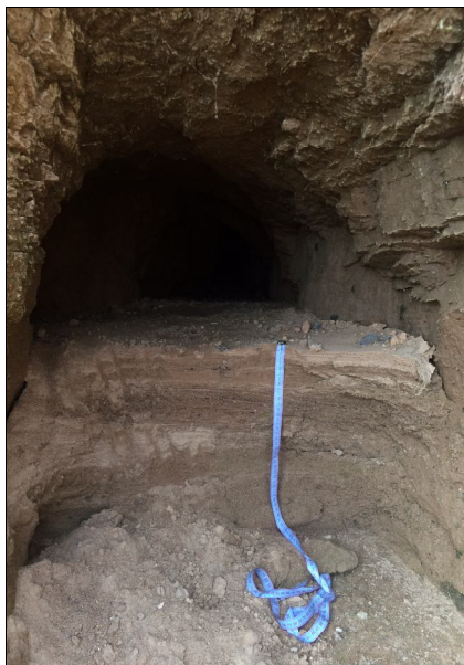
Рис. Суффозионный тоннель в лессовой толще на берегу водохранилища (фото автора)
