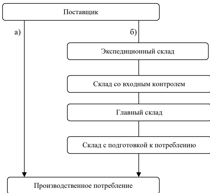
Рис. 1. Сравнительная схема снабжения*: а) традиционного и б) по системе «точно в срок»
