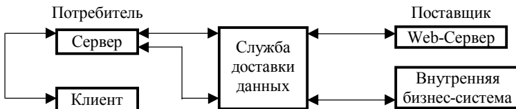
Рис. 4. Обмен информацией с помощью промежуточного программного обеспечения
