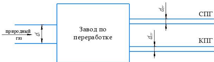
Рис. 2б. Структура газового Хаба для подачи СПГ и КПГ
