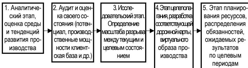
Рис. Последовательность этапов цифровой трансформации промышленного предприятия
