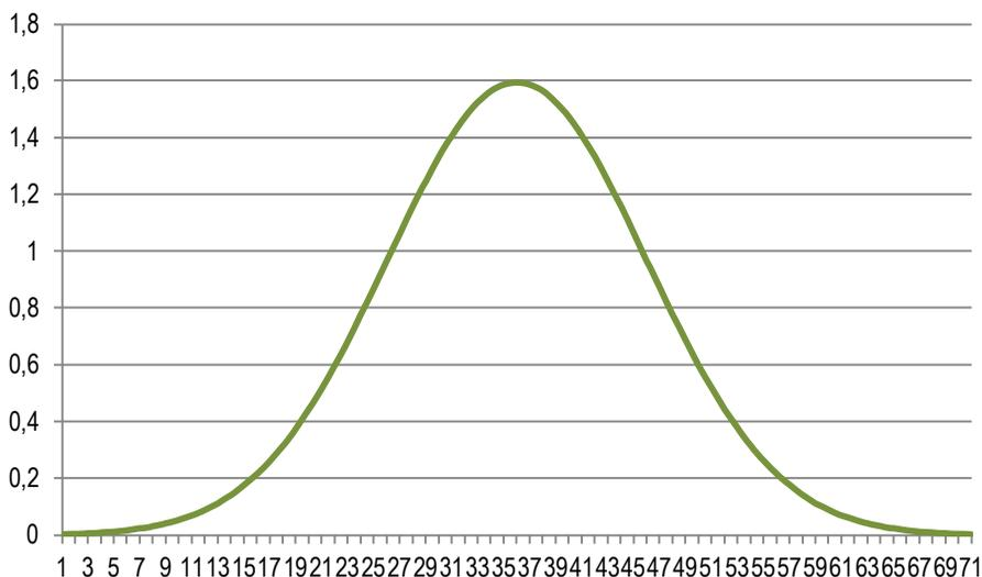
**Рис. 1. Графический вид плотности нормального закона распределения**
